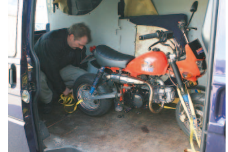
▲撮影日は雨が降りそうだったのでトランポでやってきたインゴさん。ちなみにフロントフォークはナイス110用の26φフォークを多少ツメて使用。トップブリッジなどは特注という入魂作。フロントカウルは旧型のナイス110用となっている。
