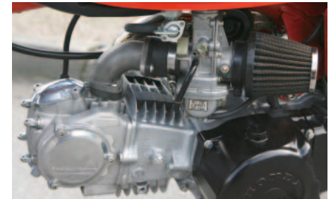
▲腰下はタイホンダ製のナイス110とされ、TJRで購入したというSP武川製のスーパーヘッド+Rキット(175cc)を搭載。キャブはミニニ製VM28φとし、パワーフィルターを装着している。
